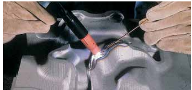
1) Boquilla de gas - 2) Protección del gas - 3) Varilla de aporte 4) Baño de soldadura - 5) Cordón de soldadura - 6) Metal base
