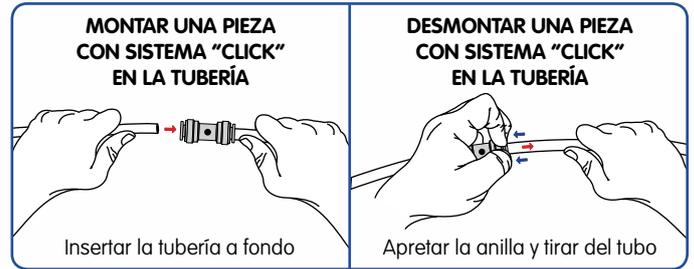
Insertar la tubería a fondo
