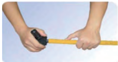
2.- Aborcardar y Redondear 2.- Abocardar e Arredondar
