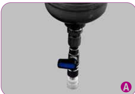
A Conecte la pérdida de referencia a la válvula (cerrada) del envase. Acercar el sensor a la protección blanca.
