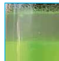
Refrigerante y aditivo con contaminación de agua
