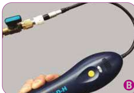
B Abrir la válvula del envase.
