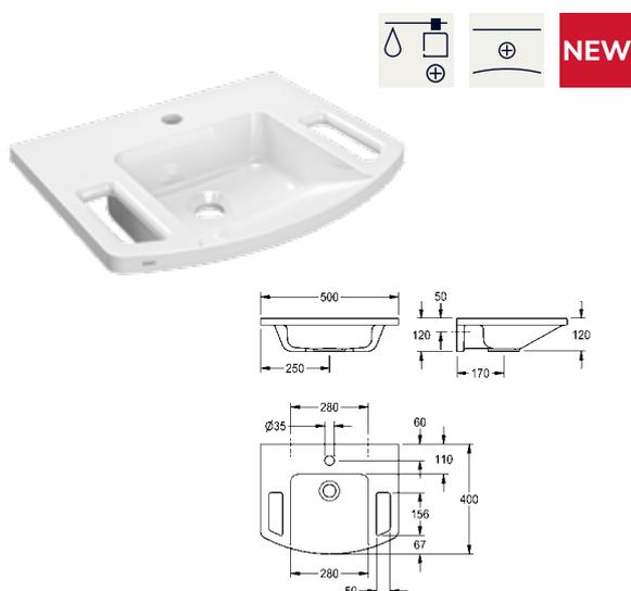
EXOS. Lavamanos de material mineral aglomerado en resina sintética MIRANIT, con superficie lisa y libre de poros (resistente a temperaturas de hasta 80 °C), color blanco alpino. Con acceso inferior, bordes de agarre integrados, superficies de apoyo, cubeta moldeada sin juntas, sin rebosadero, con orificio para grifo de 35 mm (D). Fijación a la pared posterior del lavabo, incluye material de montaje.
