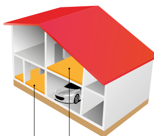
Panel sobre terreno o espacio no calefactado R= 1,25 m 2 K/W
