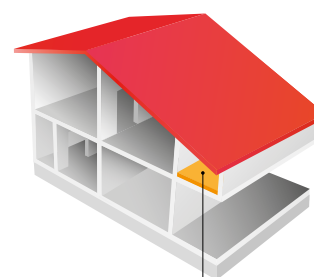
Panel sobre voladizo Temp. exteriores Hasta 0°C, R = 1,25 m 2 K/W Entre 0 y -5°C, R = 1,5 m 2 K/W Entre -5 y -15°C, R = 2 m 2 K/W
