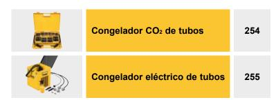
Congelación sencilla y rápida de conducciones de tubo no vaciadas con refrigerante dióxido de carbono. Para reparación y ampliación de instalaciones de tuberías.
