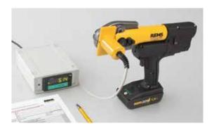
El servicio en REMS se escribe a lo grande: todos los vehiculos de demostración de los más de 200 asesores especializados de REMS están equipados con un dispositivo de pruebas, con el que se puede realizar en cualquier parte la prueba de funcionamiento y la medición de fuerza de prensado de las prensadoras radiales REMS.
