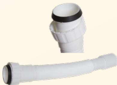
Sifón extensible/comprimible de 300mm a 760mm con junta cónica tuerca plástico.
