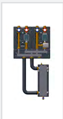
Conexión con HW80/120 e impulsión del circuito primario a la derecha
